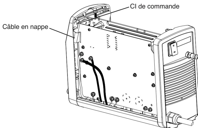
5. Mettre à l'essai le nouveau CI de commande avant de l'installer en fixant son câble en nappe au CI d'alimentation. Rétablir l'alimentation, mettre le système sous tension et vérifier que la DEL d'amorçage sur le CI de commande est la seule DEL allumée. De plus, les DEL d'anomalie sur le panneau avant doivent être éteintes.
