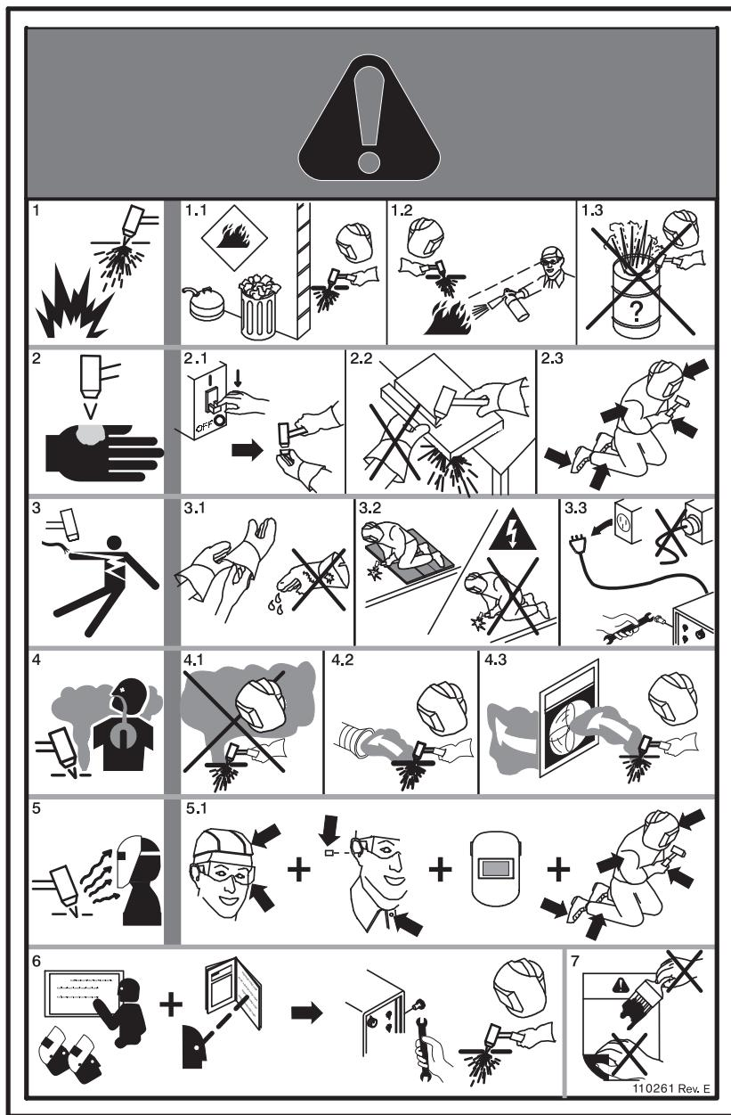
1. Las chispas producidas por el corte pueden causar explosiones o incendios.
