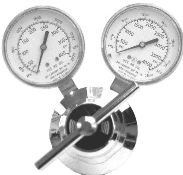
Détendeur à simple détente
