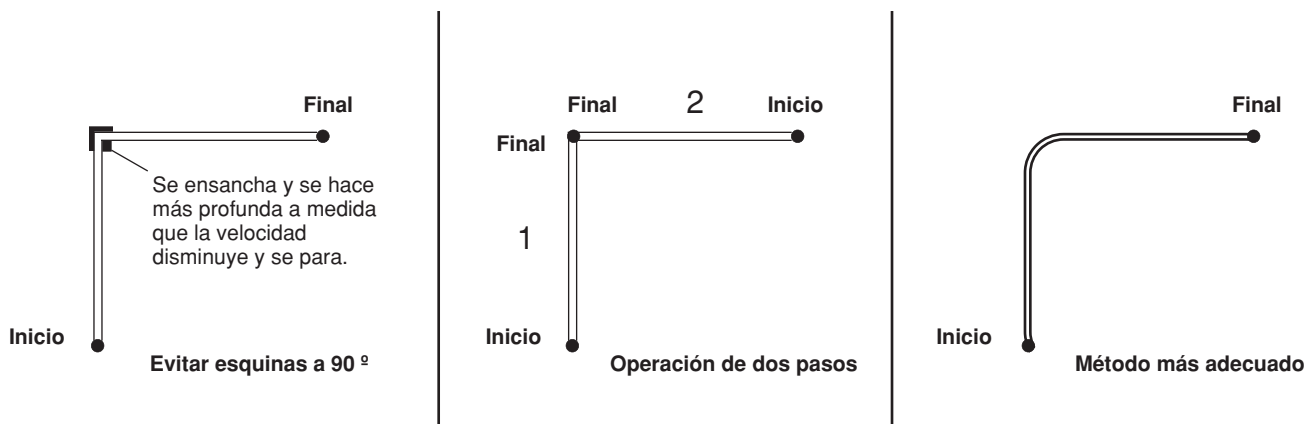
Figura 2-6 Realización de esquinas
