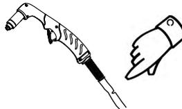
Revisar los cables y mangueras de la antorcha. Reemplazarlos si están dañados.
