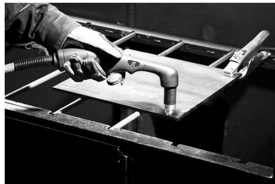
2. Oprima el gatillo de la antorcha para arrancar el arco. Quédese en el borde hasta que el arco haya atravesado completamente la pieza a cortar.
