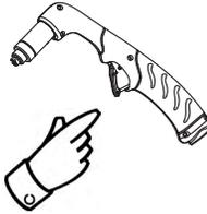
Revisar si el gatillo no está dañado. Revisar el cuerpo de la antorcha en busca de rajaduras y cables expuestos. Reemplazar cualquier pieza dañada.
