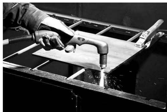
3. Arrastre ligeramente la punta de la antorcha por la pieza a cortar para proceder con el corte. Mantenga un ritmo estable y parejo.
