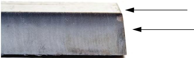
**Angle de coupe négatif** : La quantité de matériau retiré de la partie inférieure de la surface de coupe est plus importante que celle de la partie supérieure.
