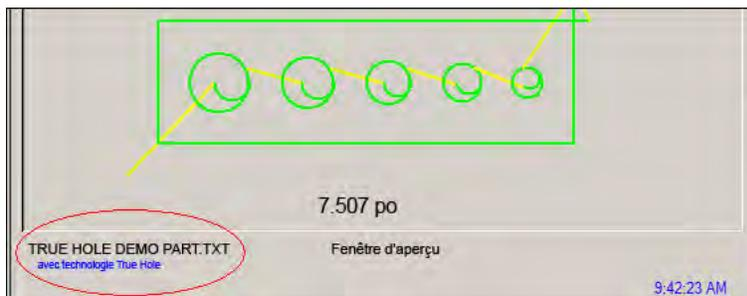
Si le texte « Avec technologie True Hole » n'apparaît pas sous la pièce True Hole, les réglages du logiciel peuvent être incorrects.
