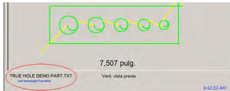
Si el texto “con tecnología True Hole” no aparece debajo de la vista de una pieza True Hole, es posible que los parámetros del software estén mal.
