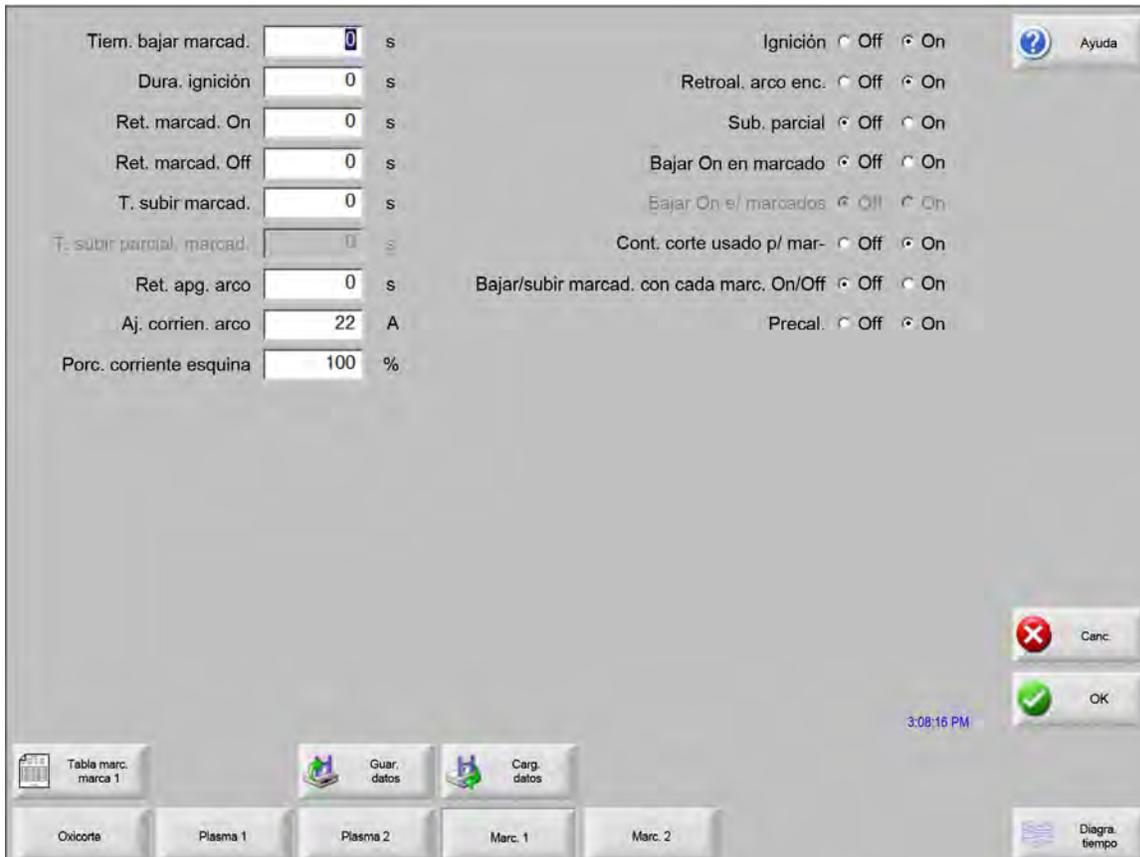
Las pantallas Proceso Marcado 1 y Marcado 2 dan opciones diferentes de acuerdo con el tipo de control de altura de la antorcha a utilizar.
