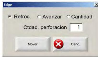
Entre los datos del punto de perforación y oprima Intro. El dispositivo de corte irá directamente al punto de perforación seleccionado.
