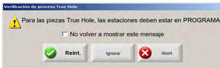
Después de ajustar los interruptores o el control de velocidad, oprima Reint. (reintentar) para ejecutar el programa de pieza.
