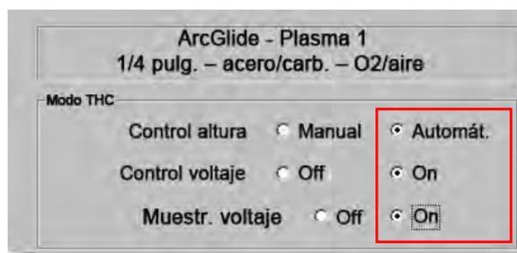
Si el voltaje del arco muestreado cambia de pronto, el CNC detiene el corte y muestra un mensaje de advertencia. Por ejemplo, si el voltaje promedio era 100 V y en el siguiente muestreo el CNC registra 115 V. Un aumento de 15 V indica que el material o la escoria podrían estar interfiriendo el arco. El CNC se detiene para que pueda corregir el problema; puede continuar el corte el oprimir Start (arranque).
