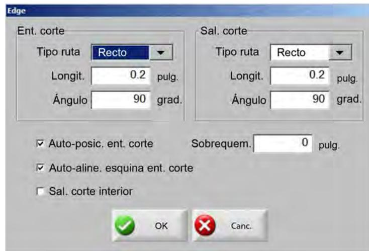
**Ent. corte y Sal. corte** En el cuadro Tipo ruta seleccione una entrada de corte o trayectoria de salida Recta o Curva.
