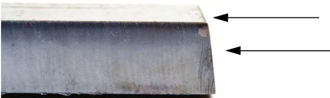
**Ângulo de corte negativo:** Mais material é removido da parte inferior da superfície de corte do que da parte superior.
