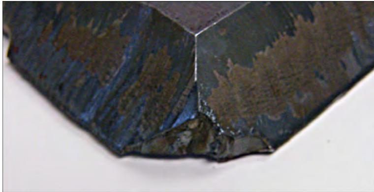
No corte chanfrado, um laço de canto é usado pelo software para reposicionar o cabeçote chanfrado quando os ângulos de corte mudam entre dois cortes. Um canto quebrado em uma peça acontece quando o laço de canto não é grande o bastante. Para corrigir o tamanho do laço, consulte o software CAM e depois produza um novo programa de peça. Abaixo estão dois tipos de laços de canto:
