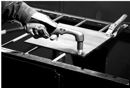
2. Appuyer sur la gâchette de la torche pour démarrer l'arc. Arrêter à l'extrémité jusqu'à ce que l'arc ait complètement traversé la pièce à couper.
