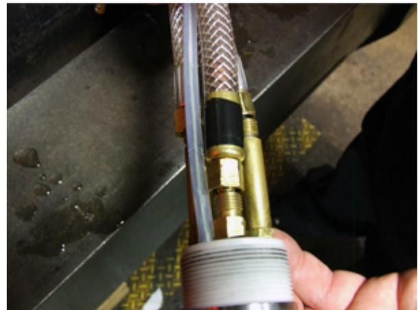
2. Connecter le câble de l'arc pilote au socle de la torche à remplacement rapide à l'aide du connecteur et serrer les vis avec la clé hexagonale de 1/16 po (PT-600) ou raccorder le connecteur du couteau (PT-36) et faire glisser l'isolateur sur cette connexion.
