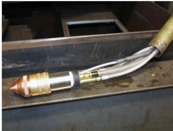
5. Faire glisser l'isolateur du câble de l'arc pilote hors de la torche et déconnecter le raccord en utilisant la clé hexagonale de 1/16 po (PT-600) ou plier le connecteur du couteau et le déconnecter (PT-36). Lorsqu'il est déconnecté, écarter le câble de l'arc pilote pour un meilleur accès aux raccords.
