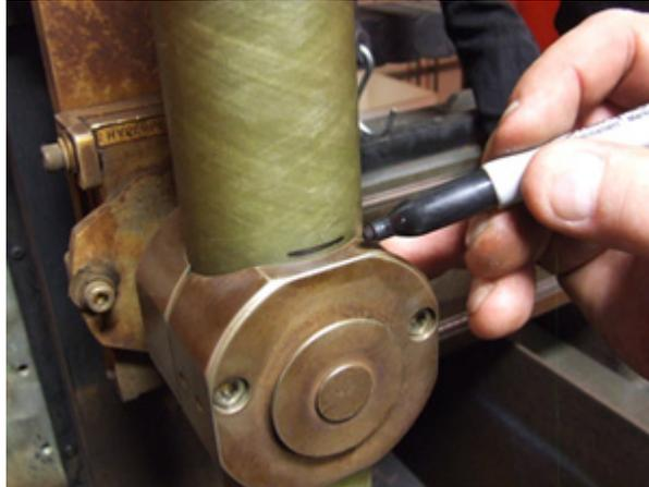
2. Utiliser une clé à courroie ou une clé à tube pour desserrer la torche du tube de montage fixé. Tourner la partie en acier inoxydable de la torche vers la gauche jusqu'à ce qu'elle se libère puis arrêter.
