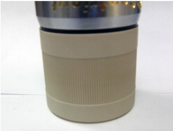
**Écrou de montage mal installé**
