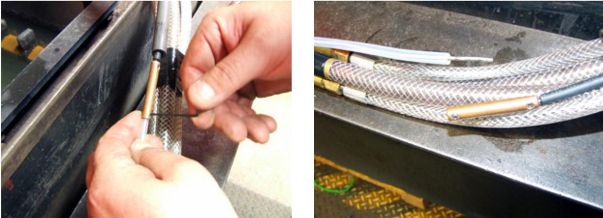
6. Utiliser la clé 1/2 po pour déconnecter la conduite de gaz de protection (le plus long tuyau avec un écrou de 1/2 po) puis les conduites d'entrée et de sortie du liquide de refroidissement (les tuyaux plus courts).
