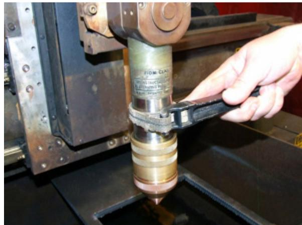
3. Desserrer les vis et la vis hexagonale de 5/32 po ainsi que l'attache couvrant le tuyau, puis retirer la torche du support en tirant sur les faisceaux de torche.
