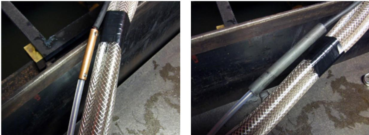
3. Glisser le tube de montage vers le bas en direction du socle de la torche puis le visser en tenant le socle de la torche et en tournant le tube dans le sens horaire. Attention de ne pas fausser le filetage.
