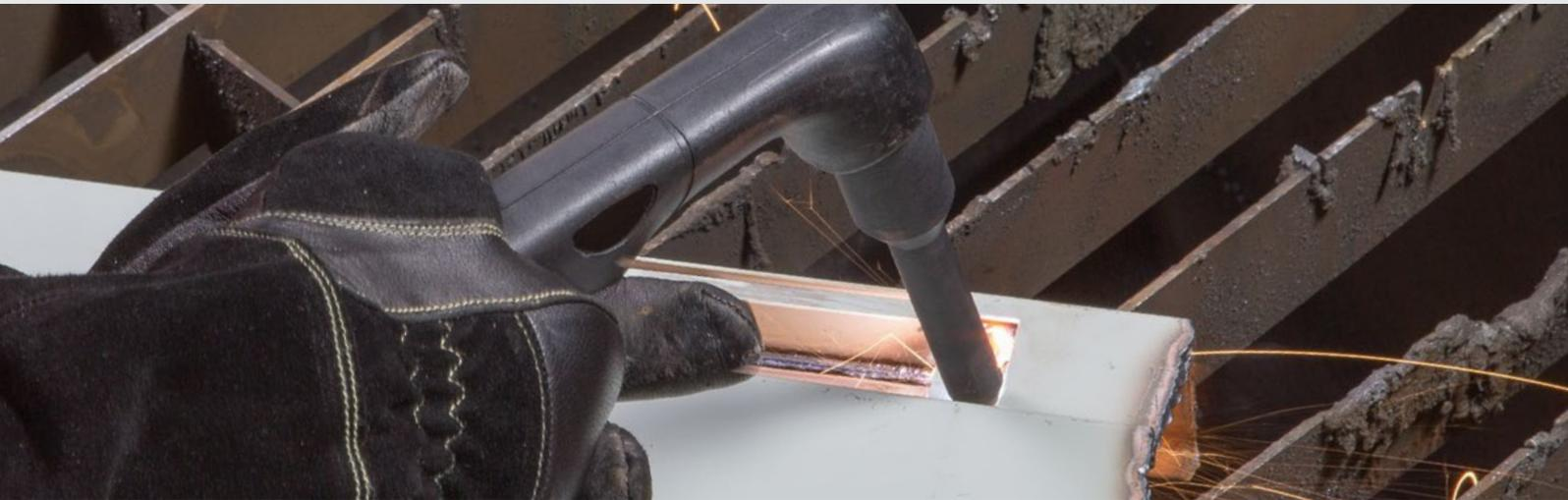
Consumíveis patenteados com comprimento extra e um perfil mais estreito para corte e goivagem em áreas de difícil acesso.
