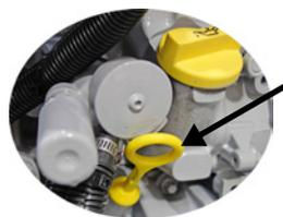
**c. Vérifier le niveau d'huile du compresseur d'air.**
