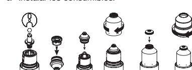
7. Montar la antorcha de desconexión rápida y el receptáculo.
