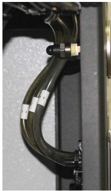
良好的低压管布线
