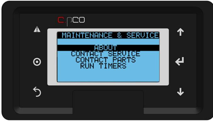
图 33：维护和维修，主菜单
