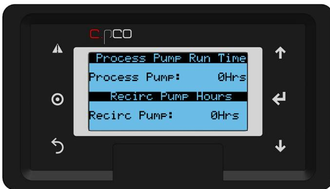
图 38：维护和维修，泵运行时间
