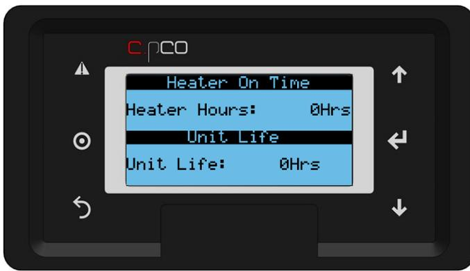
图 39：维护和维修，加热器和设备运行时间
