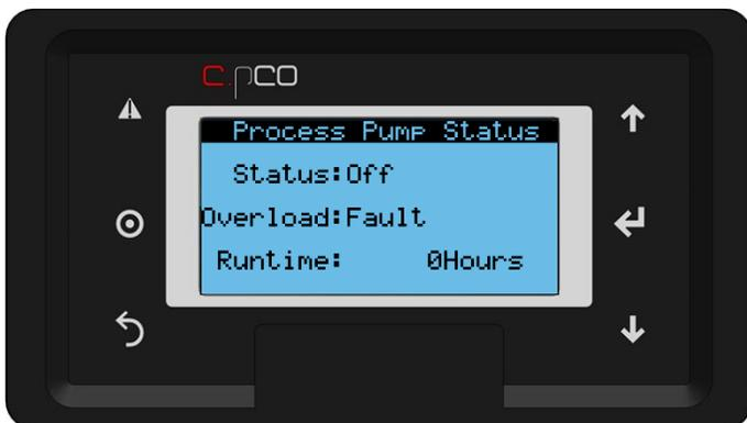
图 22 : 设备, 过程泵状态
