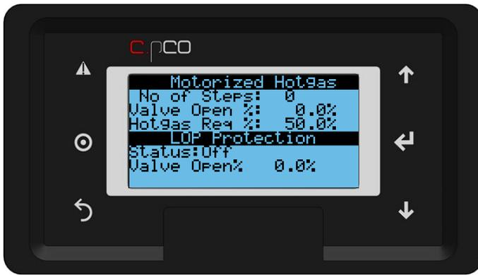
图 26 : 设备, 电动热气, LOP 保护
