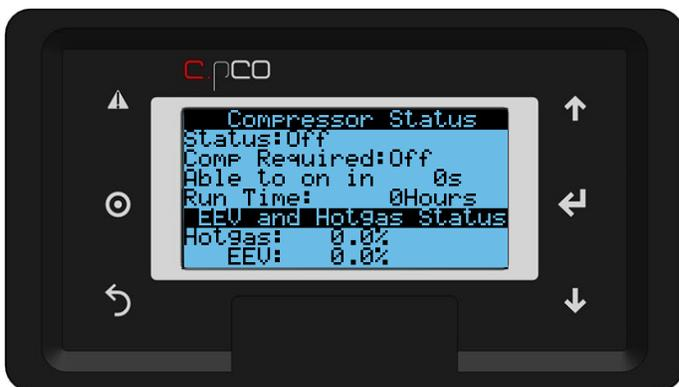
图 21 : 设备, 压缩机状态
