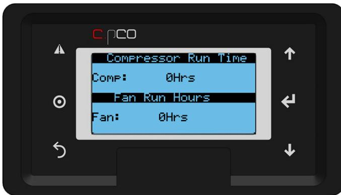
图 37：维护和维修，压缩机和风扇运行时间
