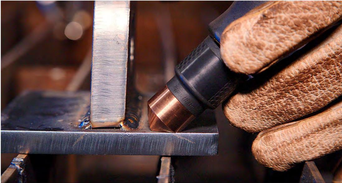
7. hale el gatillo de la antorcha para arrancar el arco. Mantenga la antorcha en posición hasta que el arco se transfiera a la pieza a cortar vertical y la atraviese por completo. El arco ha realizado un corte completo cuando las chispas salgan por el otro lado de la pieza a cortar vertical.
