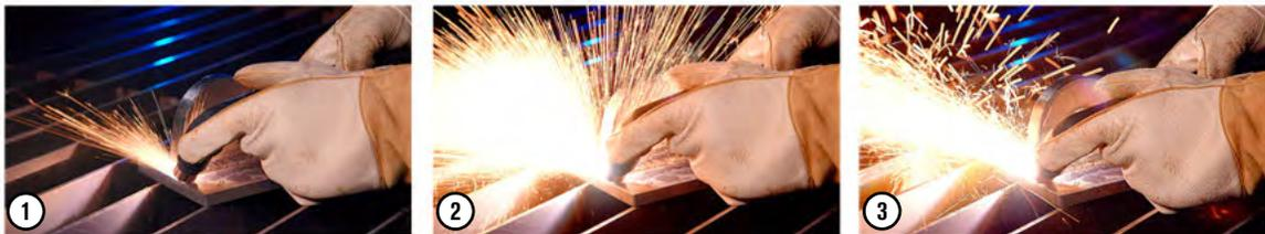
8. Trascinare il lato piatto della punta della cartuccia fino a posizionarlo a filo con la lamiera piatta. Mantenere una distanza compresa fra 3 mm – 6 mm dalla lamiera verticale. Mantenere un ritmo regolare e uniforme.
