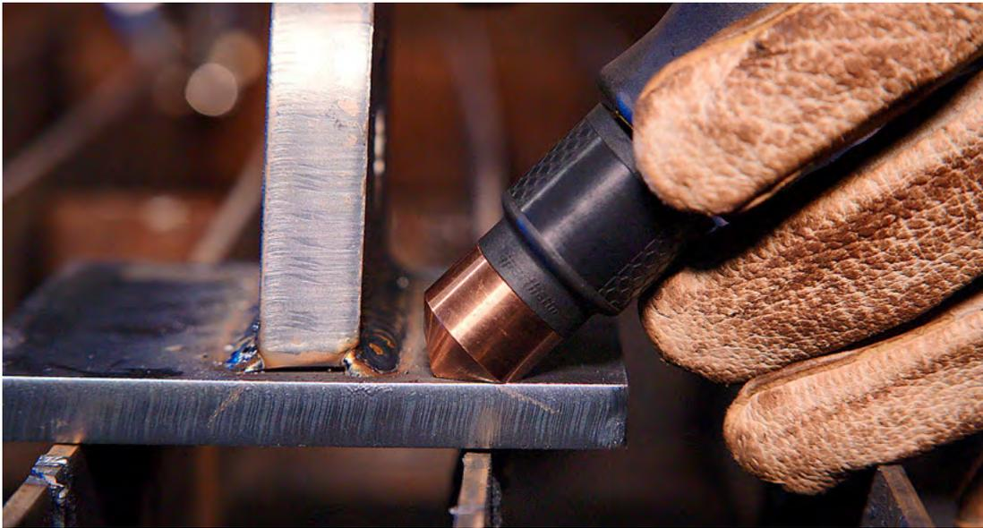
7. Tirare il grilletto della torcia per innescare l'arco. Mantenere la torcia in posizione finché l'arco viene trasferito sulla lamiera verticale per eseguire un taglio completo. Quando le scintille fuoriescono dal lato opposto della lamiera verticale, l'arco ha tagliato completamente la lamiera.
