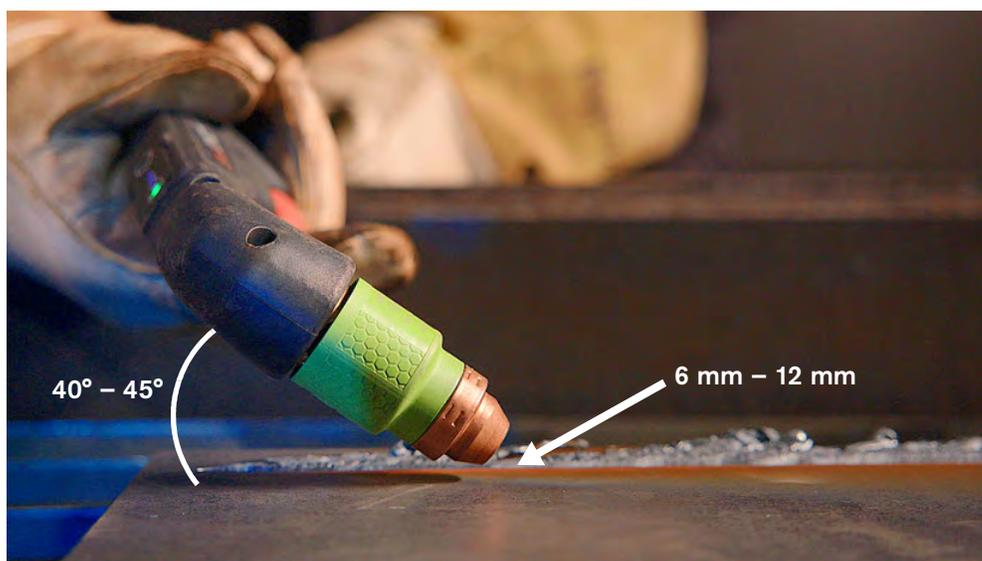
3. Tirare il grilletto per ottenere un arco pilota. Trasferire l'arco sul pezzo in lavorazione.
