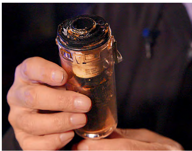
空气过滤器滤杯脏污示例
