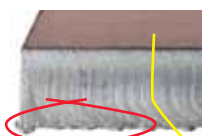
Resultado de distância da tocha à obra muito acentuada
