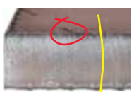
Resultado de velocidade baixa e distância da tocha à obra muito acentuada
