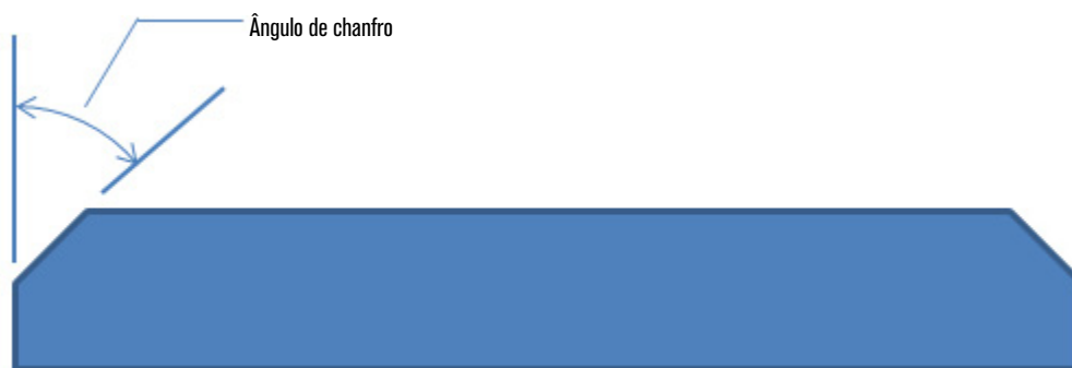
Figura 28 – Ângulo de chanfro do corte superior em Y
