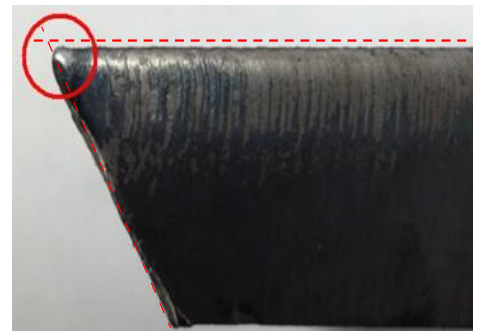
Figura 8 – Redução do tamanho da peça de corte em A devido ao arredondamento do canto superior
