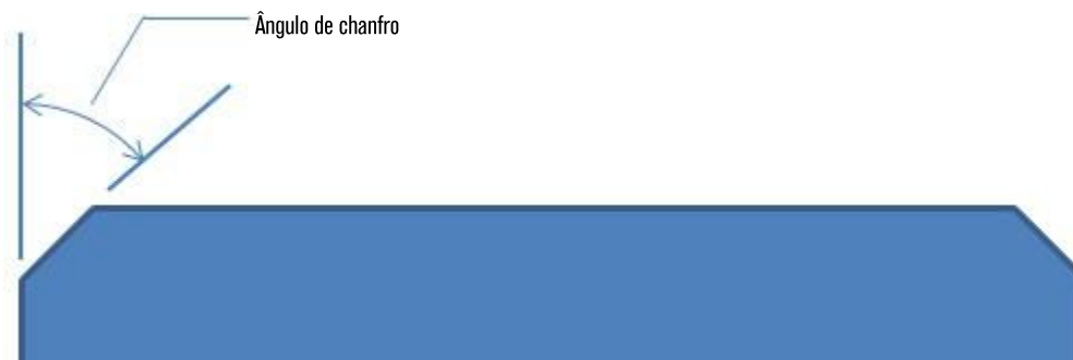
Figura 33 – Ângulo do chanfro do corte superior em Y
