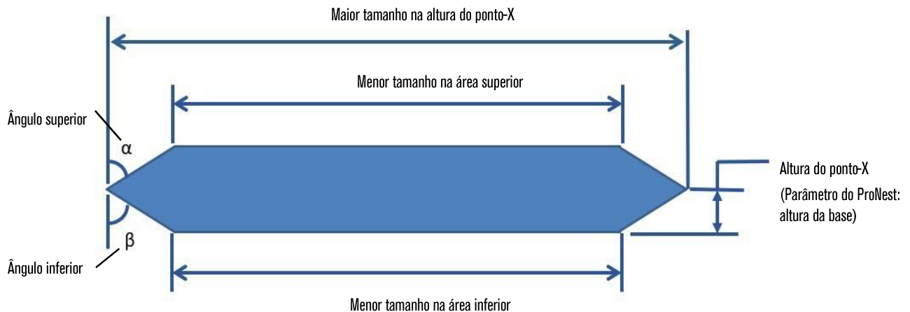
Figura 36 – Ajustes do corte em X
