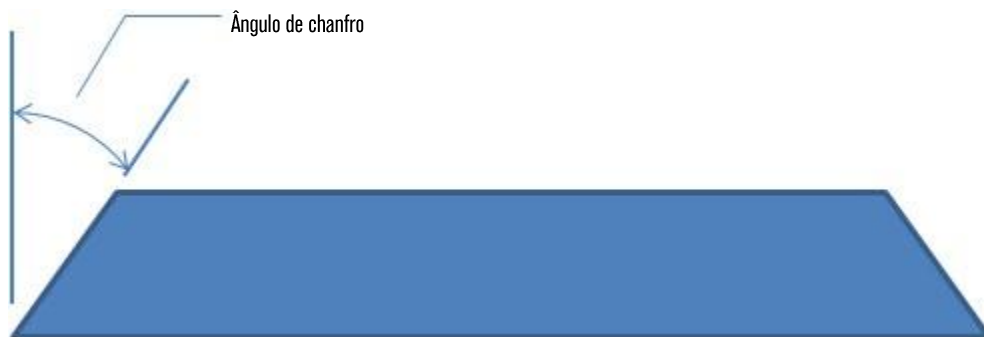
Figura 29 – Ângulo do chanfro do corte em V e do corte em A
