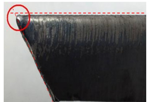
Figura 8 - Riduzione della dimensione del pezzo su un taglio ad A a causa dell'arrotondamento dell'angolo superiore
