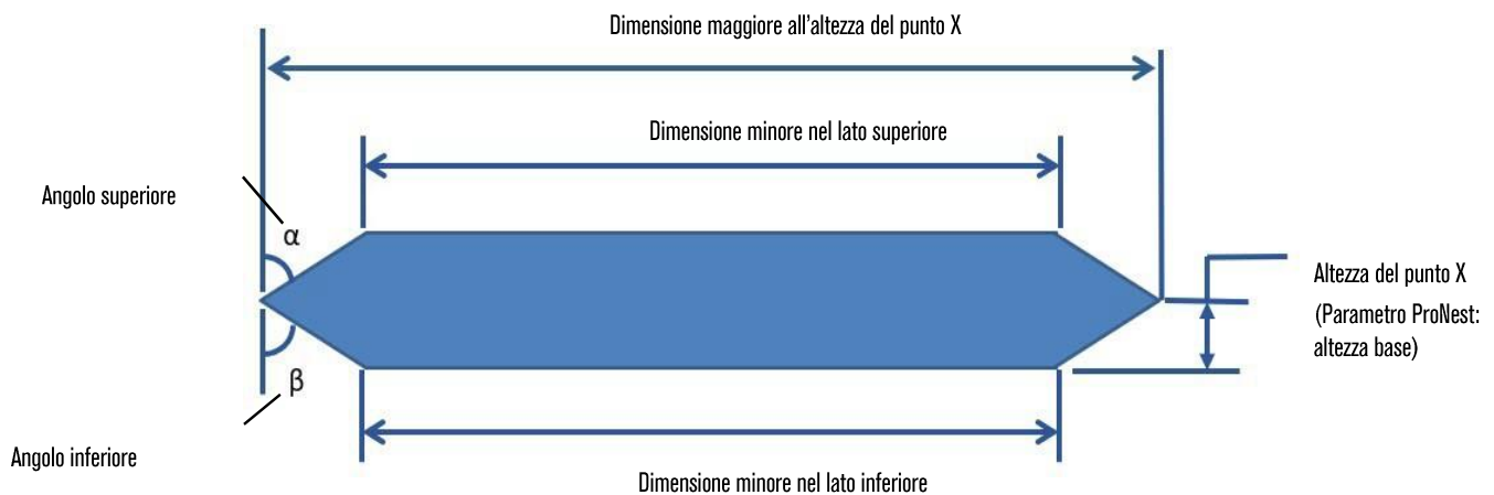
Figura 36 - Regolazioni del taglio a X
