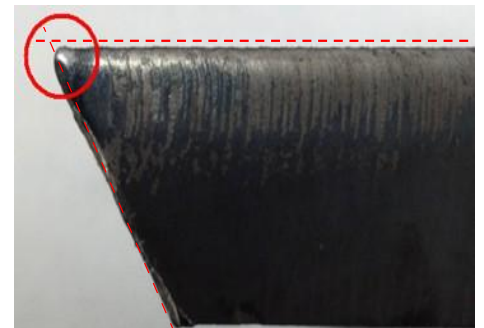
Рисунок 9. Длина участка прямого реза для Y-образного скоса (сверху)
