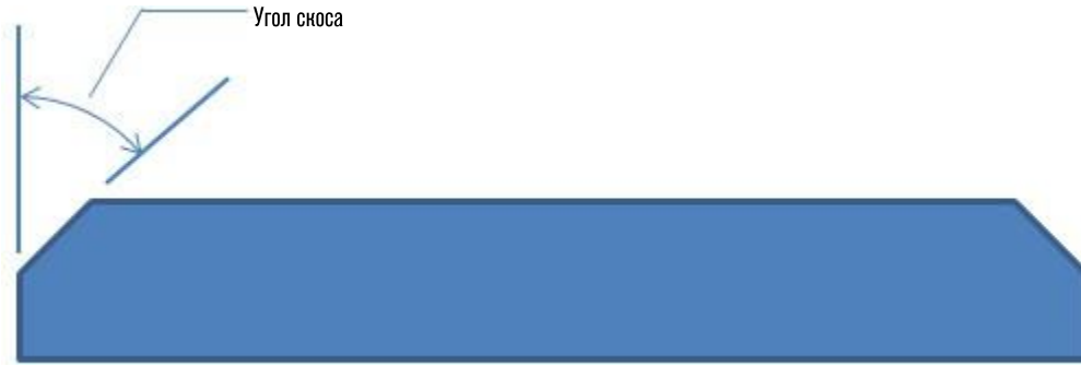
Рисунок 33. Угол скоса на детали с Y-образным скосом (сверху)
