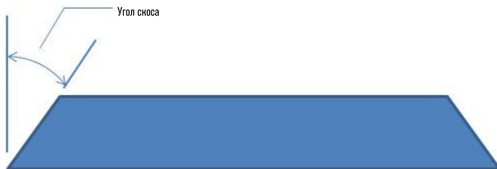
Рисунок 29. Угол V- и A-образных скосов
