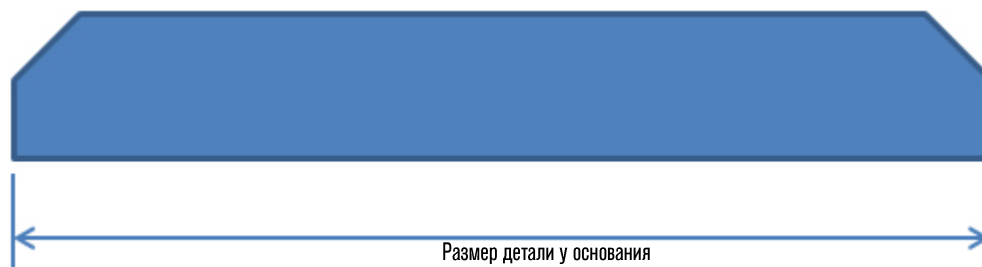
Рисунок 32. Размер основания детали с Y-образным скосом (сверху)
