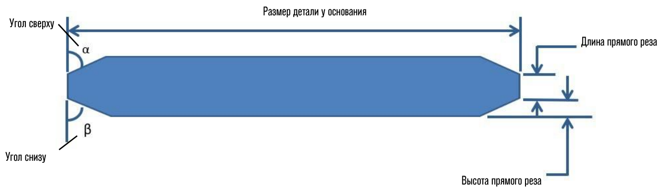
Рисунок 39. Коррекции К-образного реза
